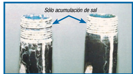
Ejemplos de roscas galvanizadas por inmersión en caliente después de 42 días de la prueba de niebla salina
