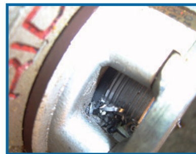
Para evitar la obstrucción, utilice un cuchillo y marque el conducto a lo largo desde el punto en que la rosca termina hasta donde comienza. Esto permitirá que el PVC y virutas de metal caigan en la garganta del cabezal de roscado.
