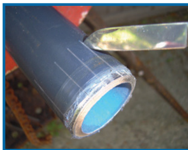
Para evitar la obstrucción, utilice un cuchillo y marque el conducto a lo largo desde el punto en que la rosca termina hasta donde comienza. Esto permitirá que el PVC y virutas de metal caigan en la garganta del cabezal de roscado.
