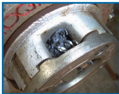
Los dientes de corte son roscas cónicas de corte y se obstruyen con PVC y virutas de metal.
