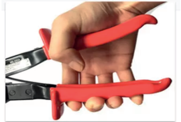
2. Presiona el mango repetidamente Para conducir la cuchilla para cortar.
