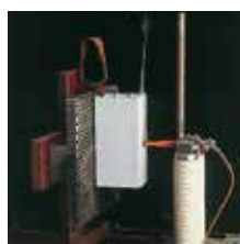
Attrezzatura per prova calore anormale (850°C) GWT.
