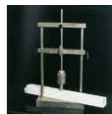
Attrezzatura per prova urti a bassa temperatura.
