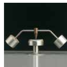
Attrezzatura per prova resistenza al calore.
