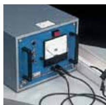
Attrezzatura per prova resistenza di isolamento oltre 100MΩ.
