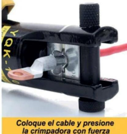
Coloque el cable y presione la crimpadora con fuerza
