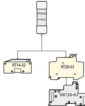
Diagrama esquemático correspondiente al soporte del protector de fusible (base) y a los elementos fusibles con un tamaño de 122x58
